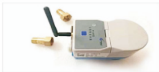
1、检查水表配件、安装天线
