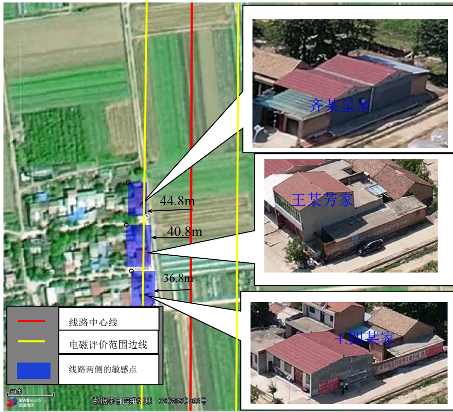
图 2.6-13 本项目线路敏感点（西王家村齐某星家、王某芳家、王四某家）
