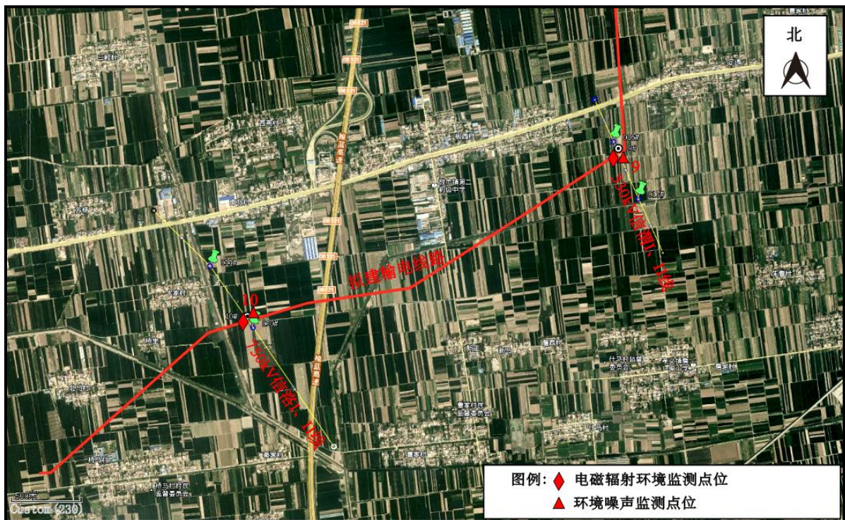
图 4.4-23 拟建线路与 330kV 信渭 I、II 线跨越点、750kV 信洛 I、II 线钻越点监测点位示意图
